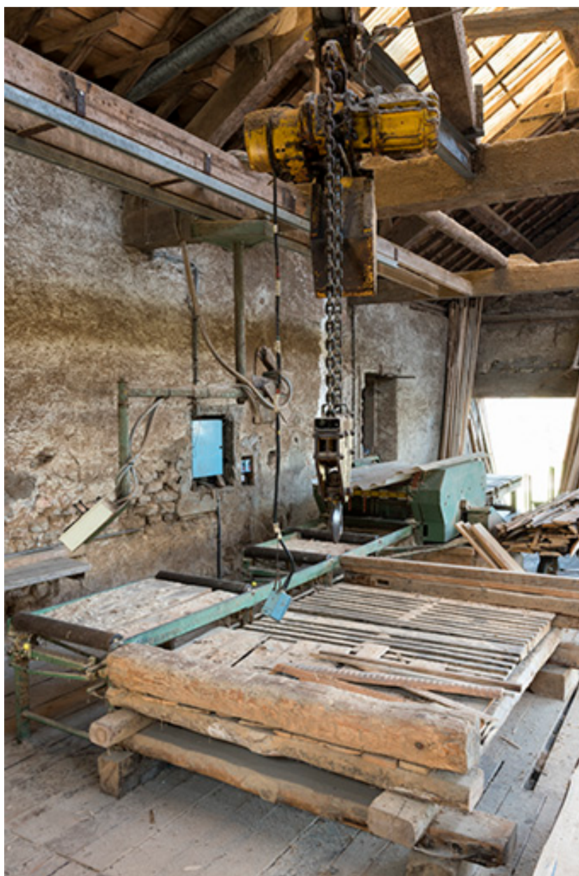
Atelier de fabrication : palan et déligneuse Esterer.
