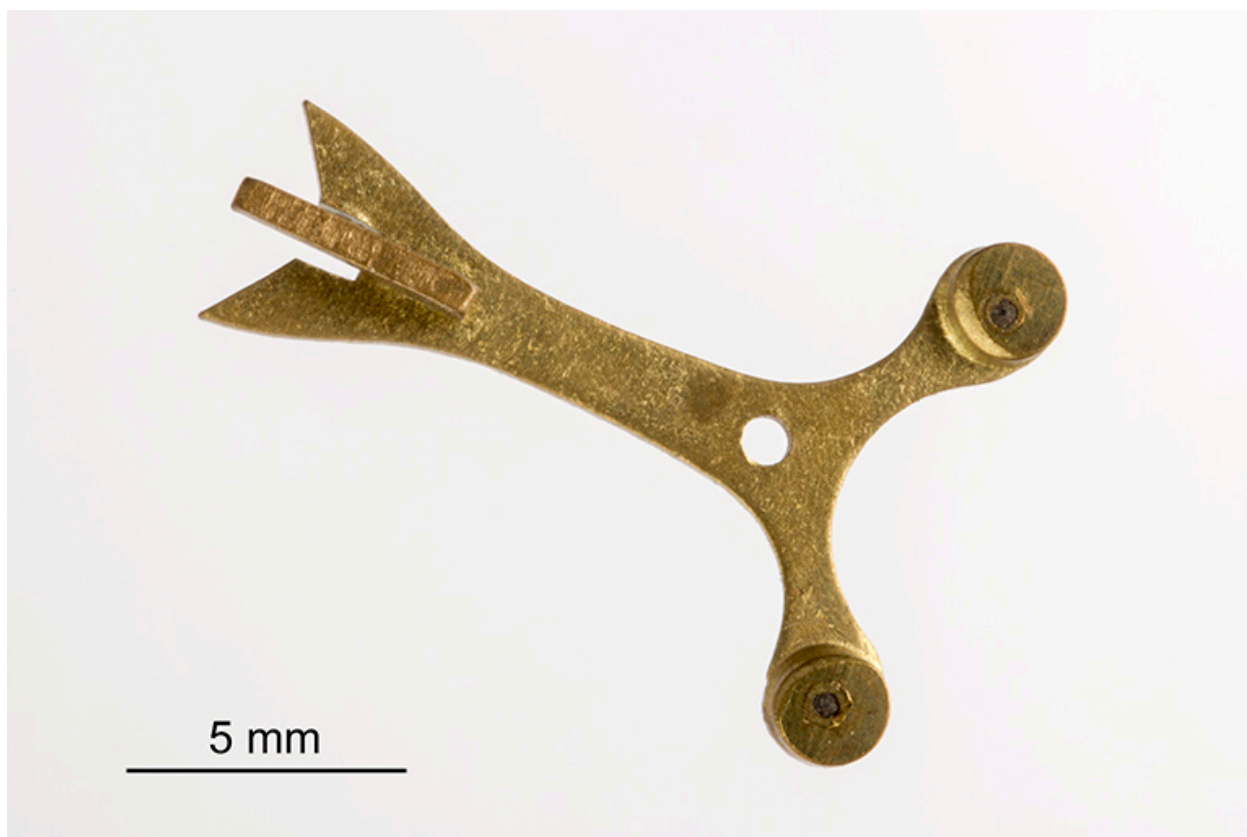
Echappement à chevilles : ancre (2e face).
