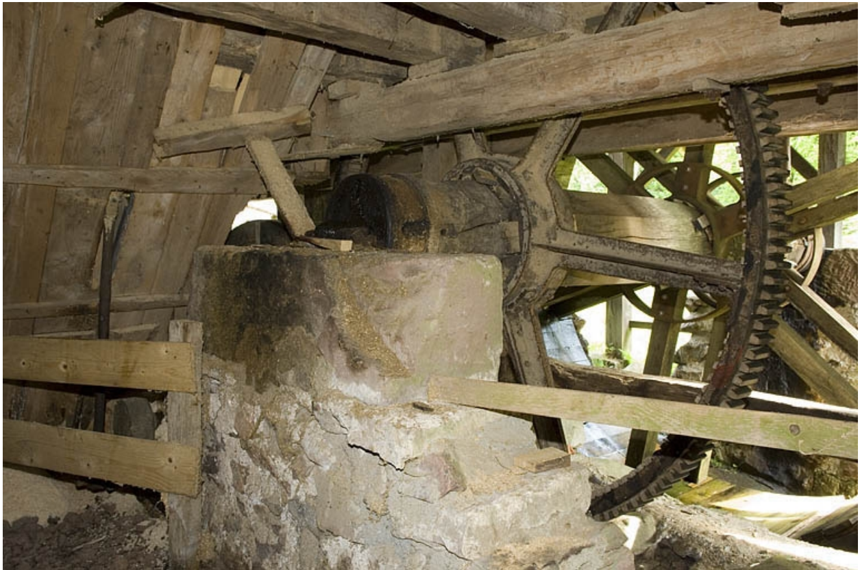
Etage de soubassement. Détail de la transmission par engrenage.
