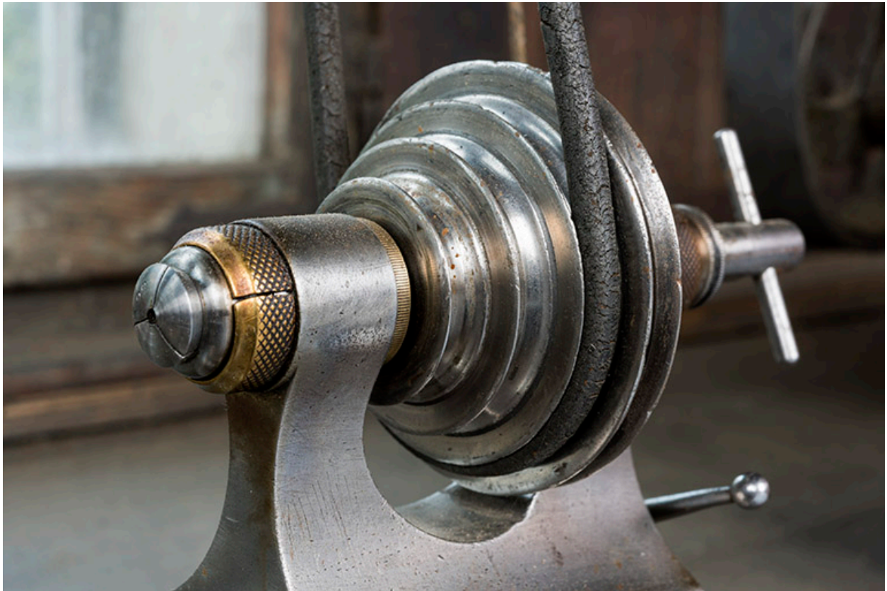
Lunette double avec l'arbre moteur, sa poulie et la pince (à gauche).
