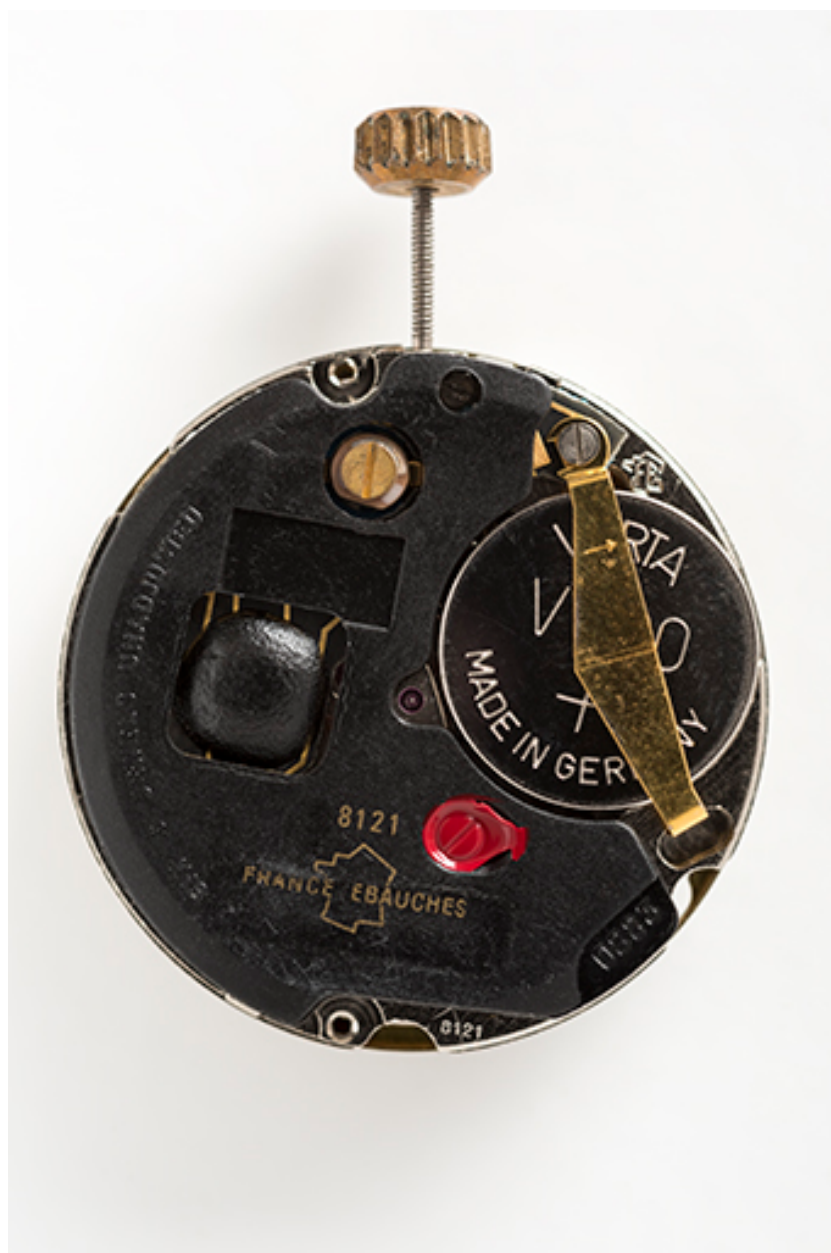
Module de montre à quartz France Ebauches FE 8121.
