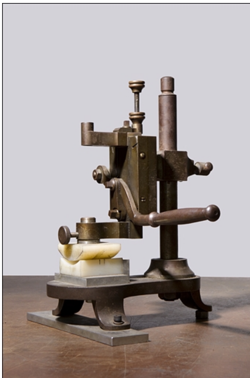
Usine Gouverneur-Audigier, Morez : machine à cintrer les faces, à coulisseau vertical.
