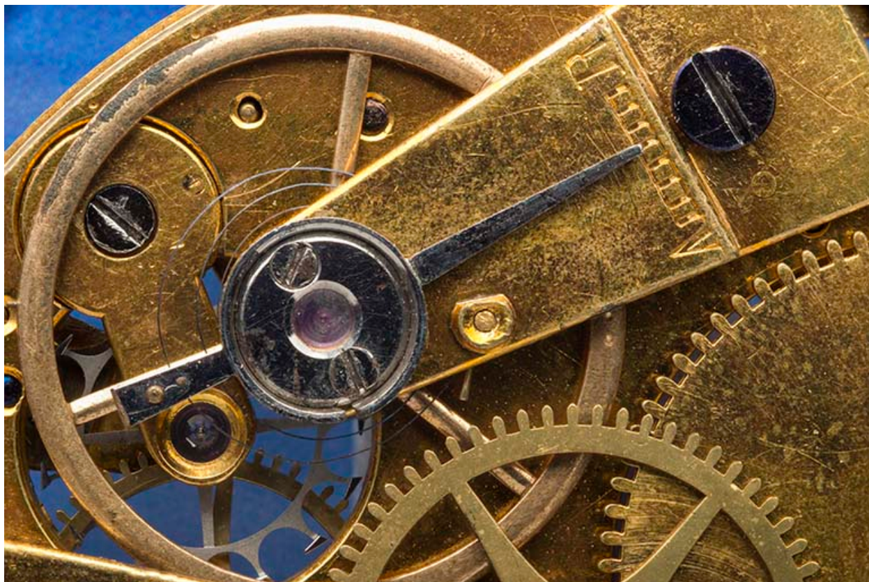
Détail de la face côté ponts : balancier-spiral, coq et raquette.
