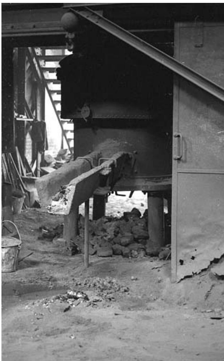
Base du grand cubilot et sa rigole de coulée.
