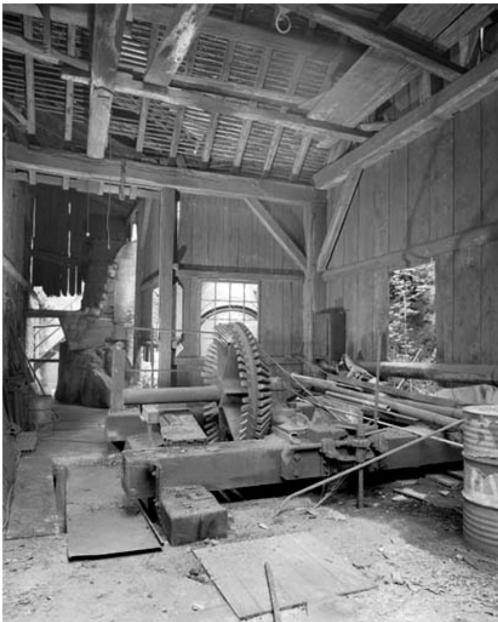
Engrenages de l'ancienne turbine du laminoir.
