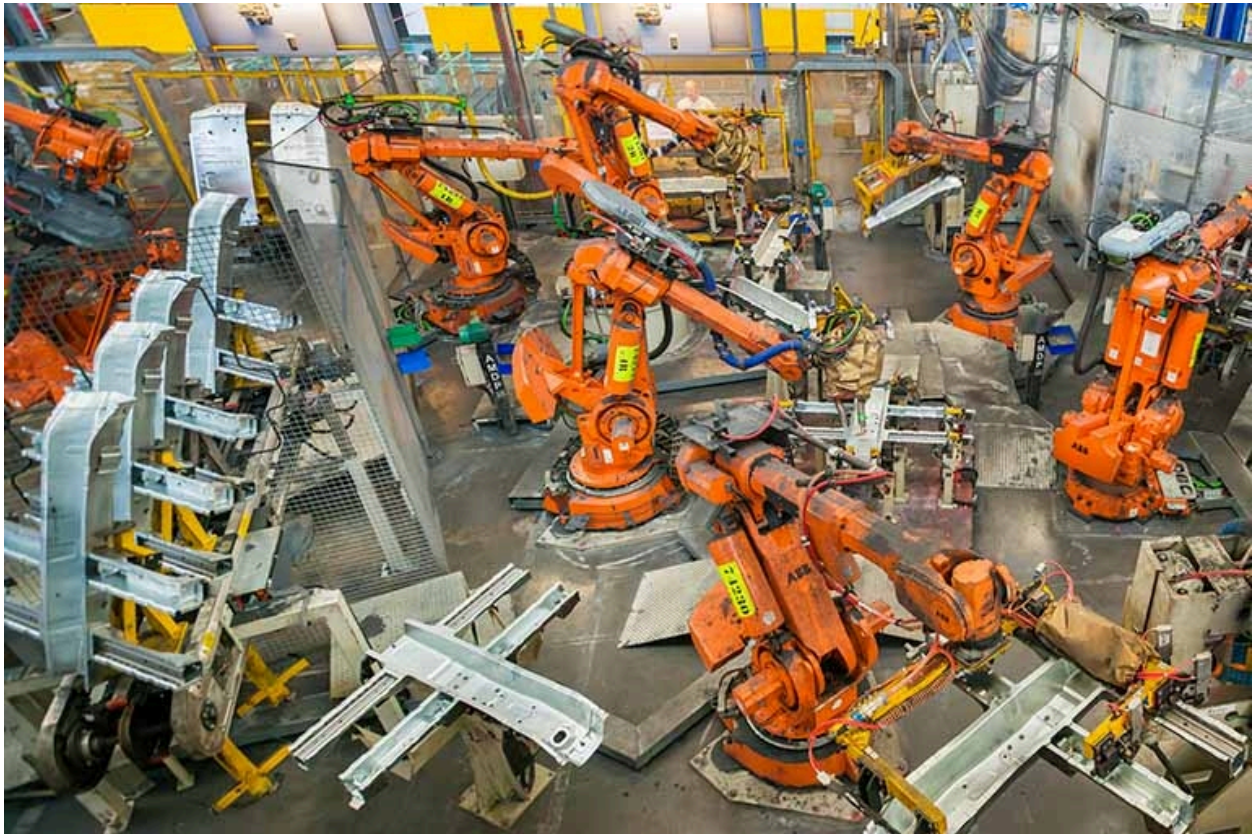
Atelier de ferrage. Soudage des pièces de la caisse en blanc dans un îlot robotisé (1).
