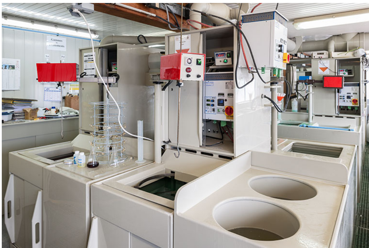
Usine : atelier de galvanoplastie.
