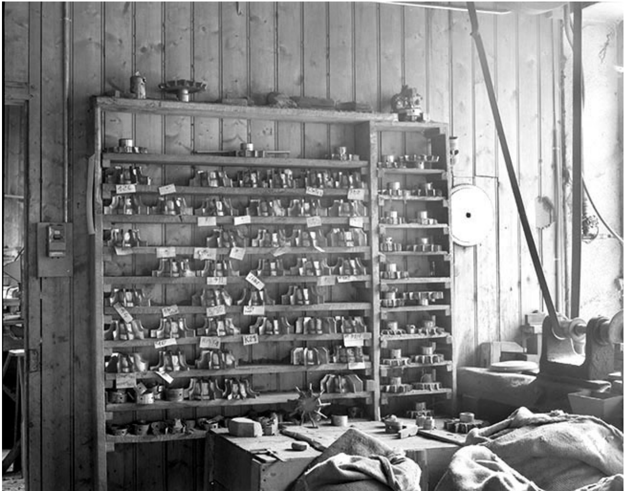
Atelier de mécanique : fraises pour l'ébauchage.
