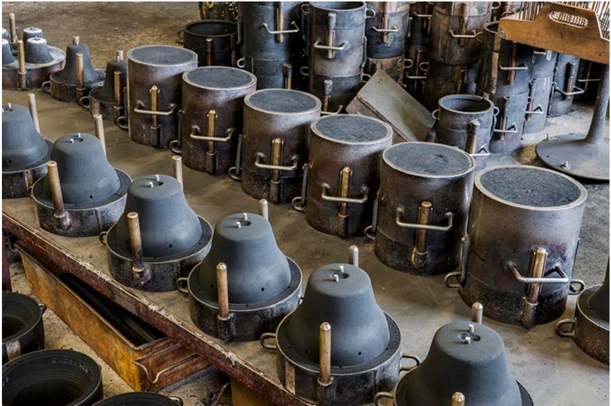
Châssis et moulages en attente.
