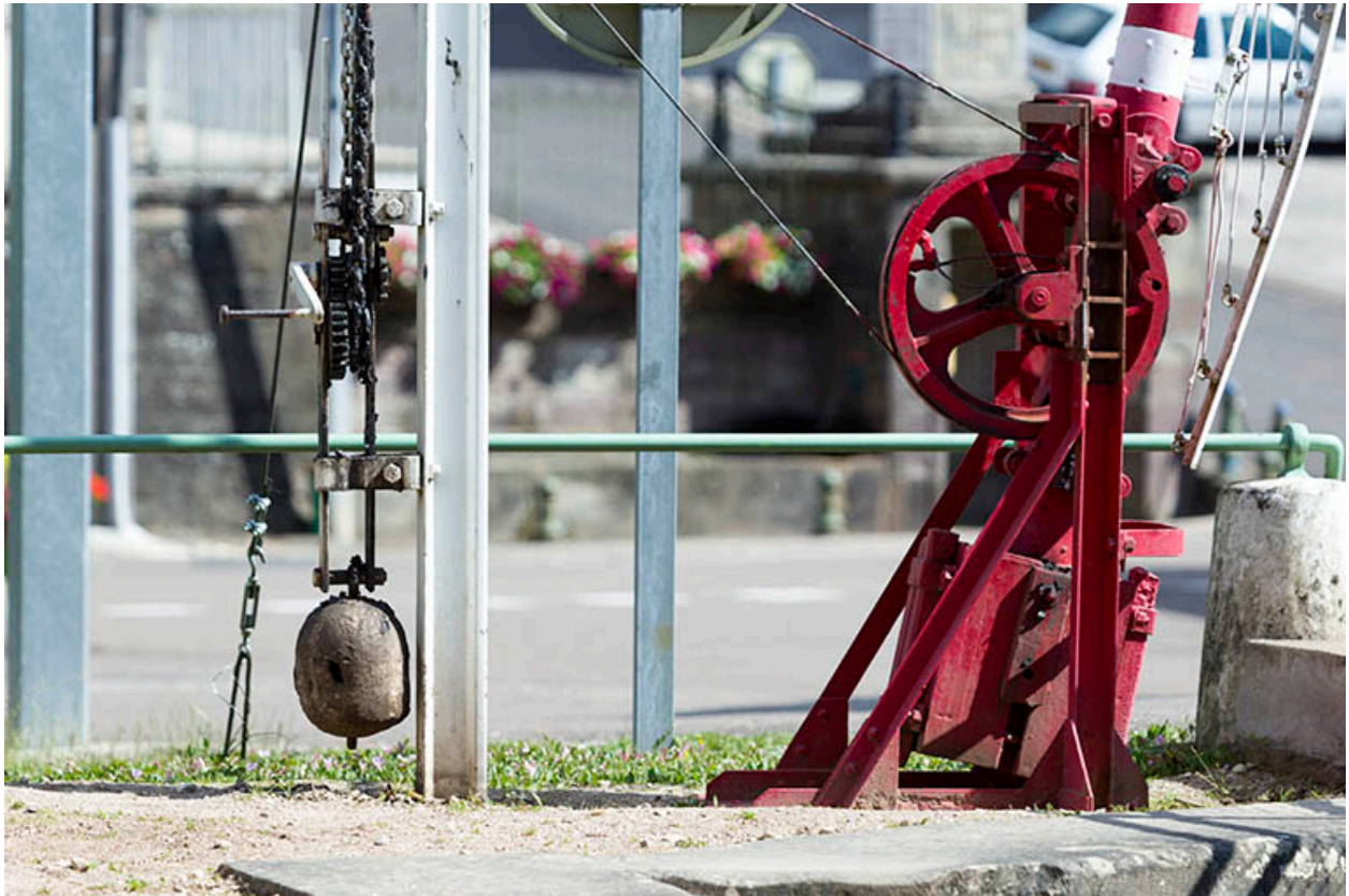
Détail du mécanisme de la barrière.
