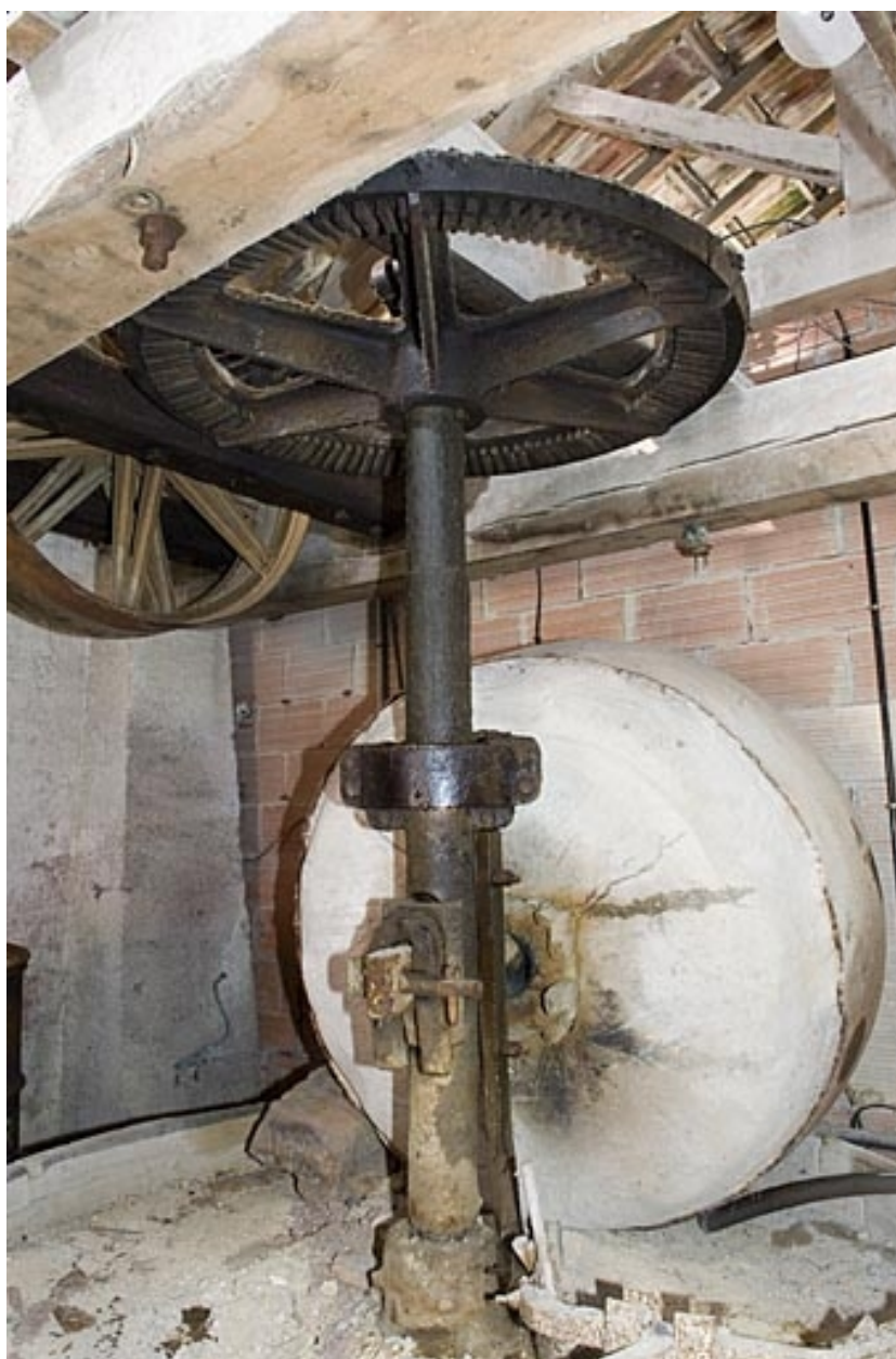
Meules de broyage de la terre (atelier dit pilerie). Détail de la transmission.
