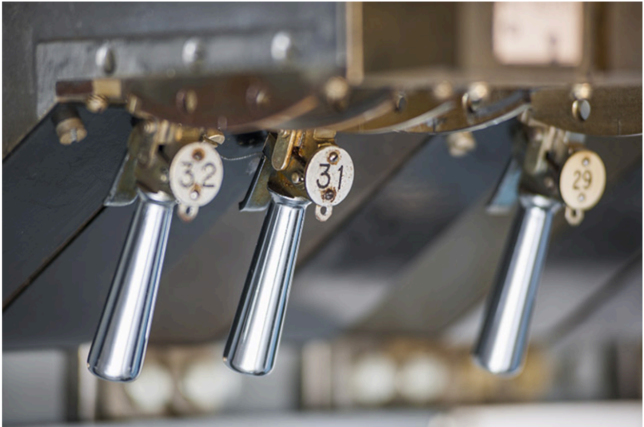
Gare de Port-d'Atelier, poste d'aiguillage : détail des manettes de commande de la signalisation.
