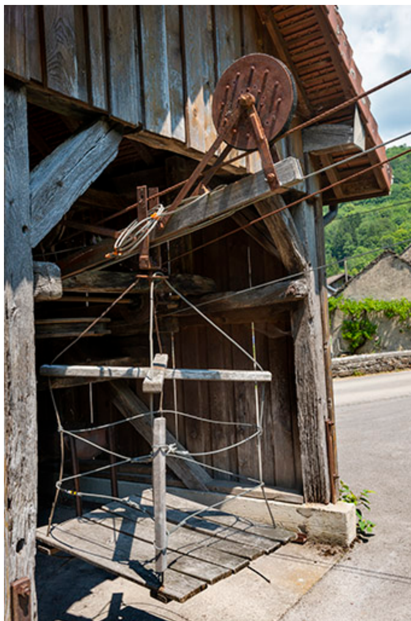
2020. Transporteur automatique par câbles : vue de la cage de dépôt des bidons.
