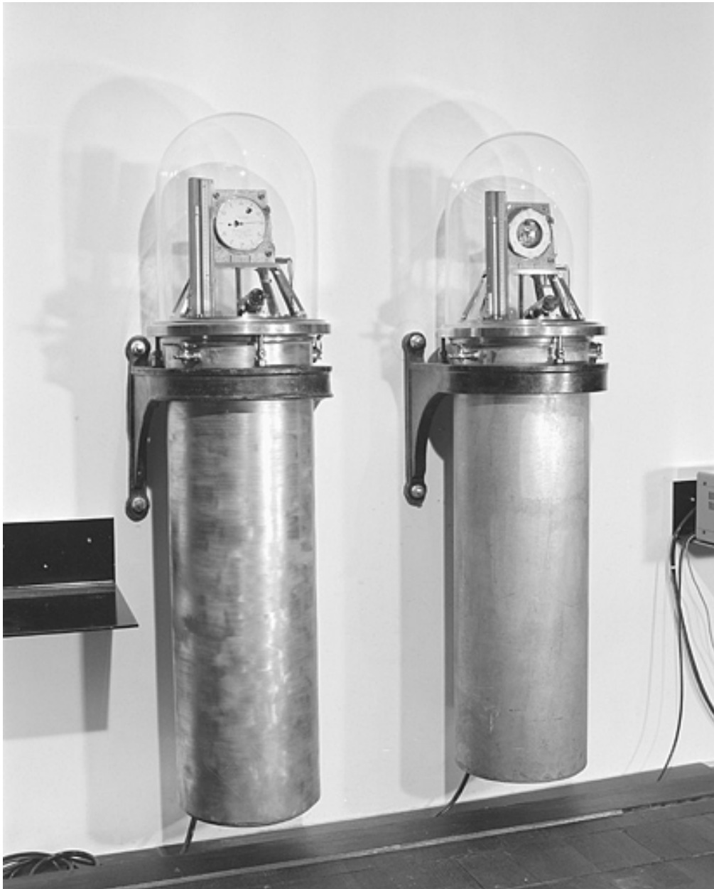
Deux horloges à pression constante (Leroy n° 1450 et 1723, exposées au Musée du Temps).
