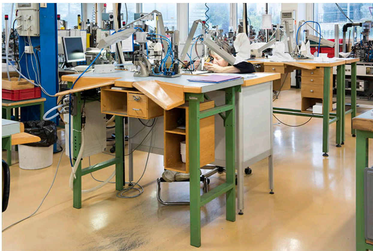
Atelier d'assemblage : poste d'assemblage manuel (établi d'horloger).
