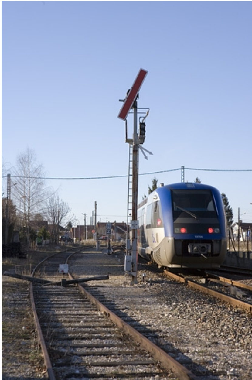
Sémaphore côté Andelot-en-Montagne : position ouverte pour le passage d'un autorail X 73500.
