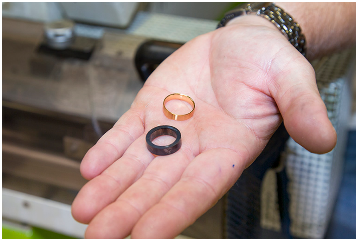
Usinage : rondelle en or noir avant et après usinage.
