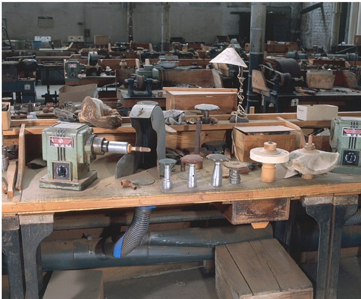
Vue d'ensemble d'un polissoir, de ses différents mandrins et de la bouche d'aspiration des poussières (atelier principal).
