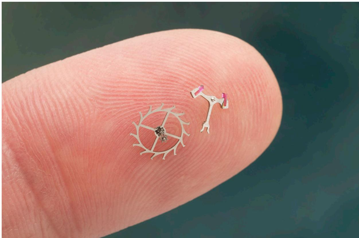
L'échappement à ancre : de la micromécanique.
