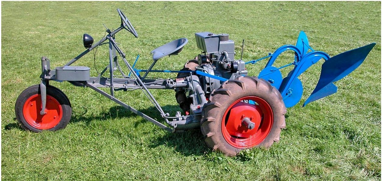
Kiva à moteur à essence Chaise, équipée d'une charrue à deux socs.
