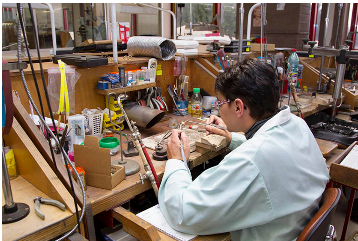
Atelier de finition et réparation : mise à dimension d'une alliance.
