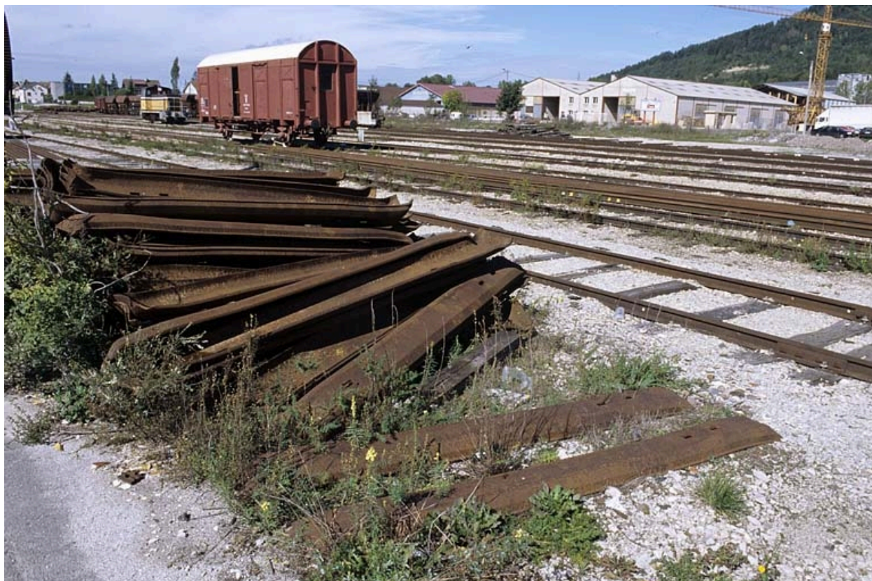
Traverses métalliques réformées stockées en gare de Champagnole.
