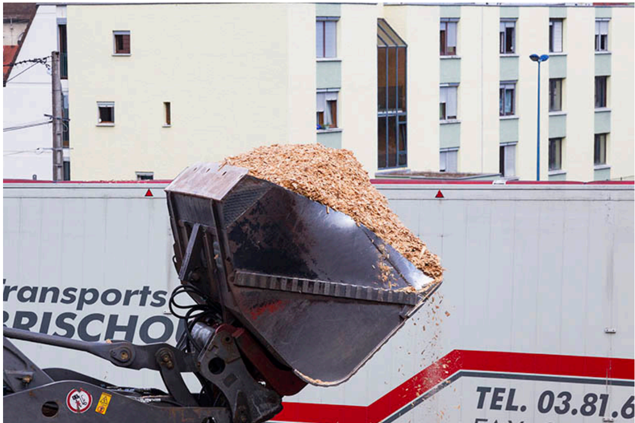
Silos à copeaux (B) : godet du chargeur.
