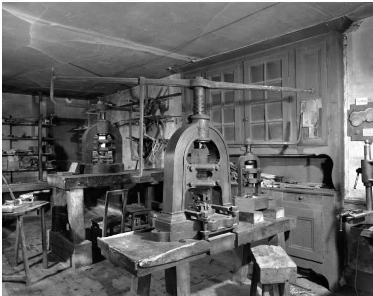
Presses à vis à balancier.
