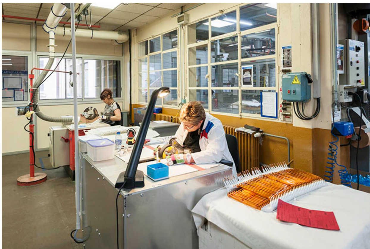
Isolation semi-automatique des barres de cuivre.
