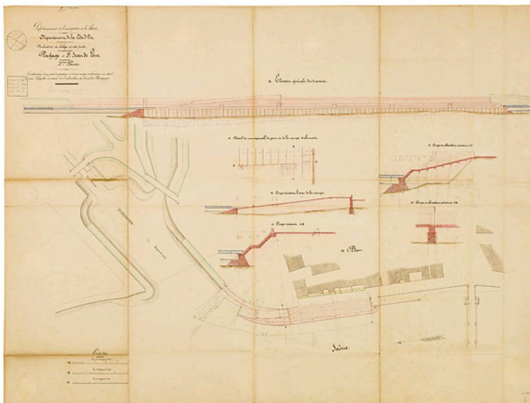
Construction d'un port à gradins et d'une rampe d'abreuvoir au droit du quai Lafayette en amont de l'embouchure du Canal de Bourgogne. Elévation, plan et coupe.
