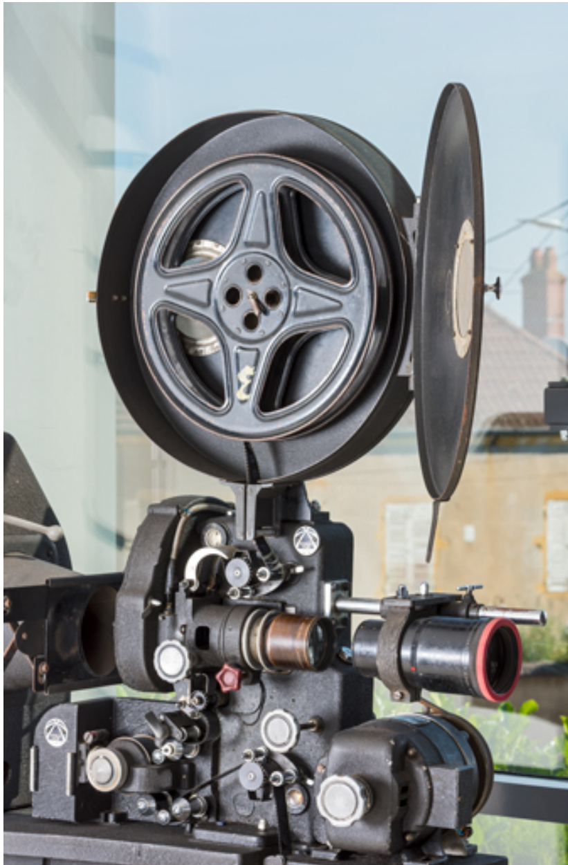
1er projecteur : porte-bobine ouvert et chrono (avec optique et moteur électrique).
