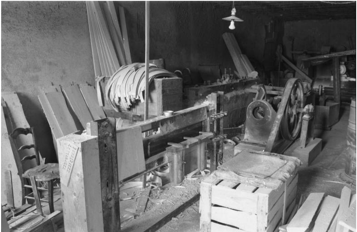
Vue d'ensemble de la targeuse, du côté d'application du bois. Rabot à gauche, système moteur à droite.
