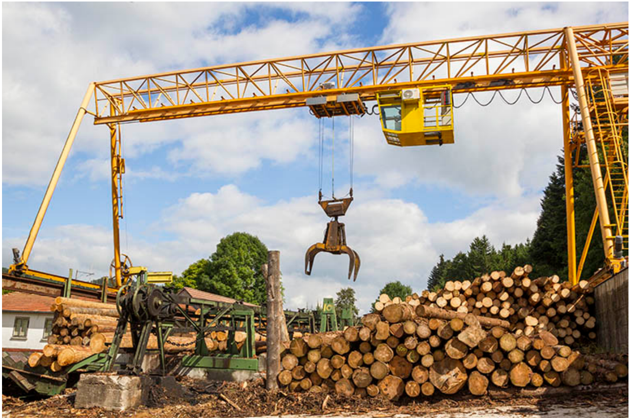
Portique roulant : déplacement de la pince.
