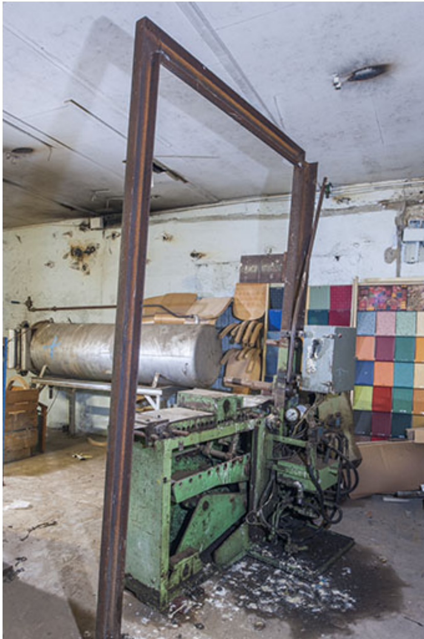
La cintreuse et son portique.
