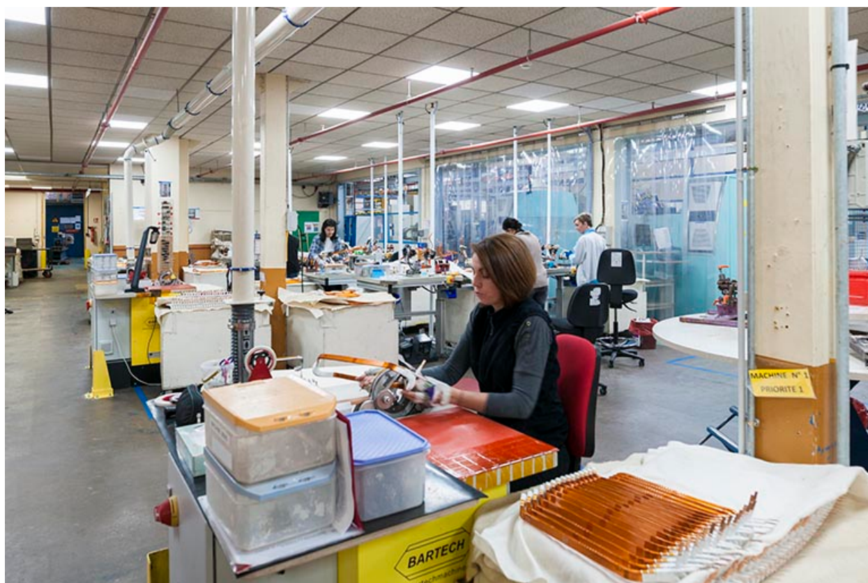
Isolation semi-automatique des barres de cuivre.
