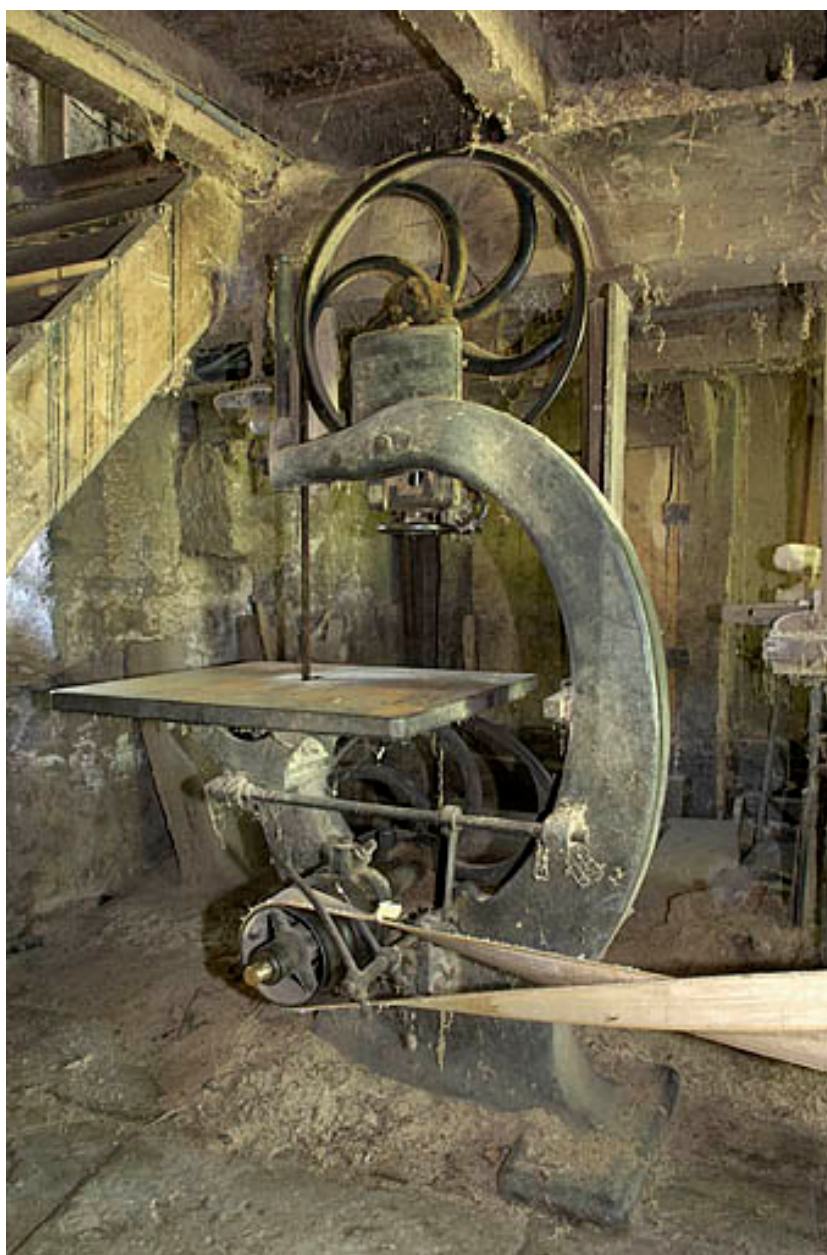
Rez-de-chaussée. Scie à ruban J. Guillet - Egré et Cie.
