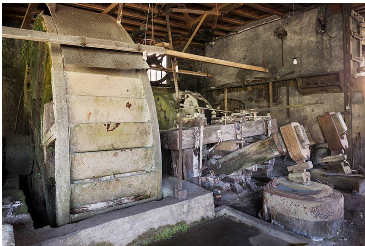
Roue hydraulique et les deux martinets ouest.
