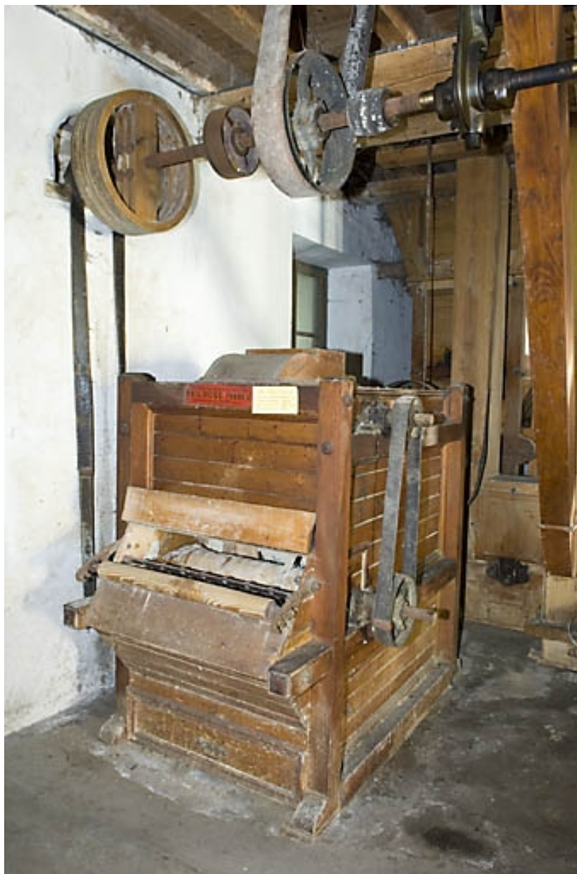
Rez-de-chaussée. Batteuse-nettoyeuse de sacs de jute H. et G. Rose Frères.
