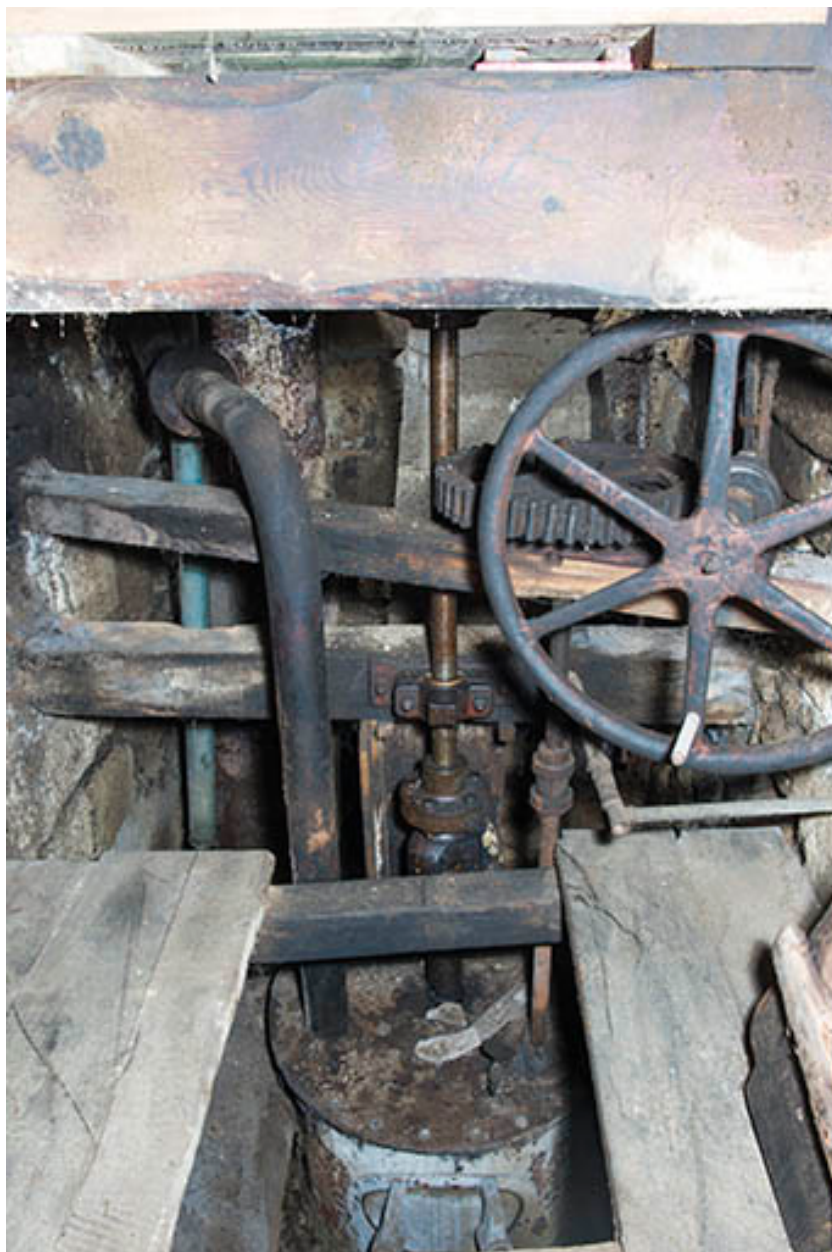
Mécanisme de débrayage de la turbine (visible en bas).
