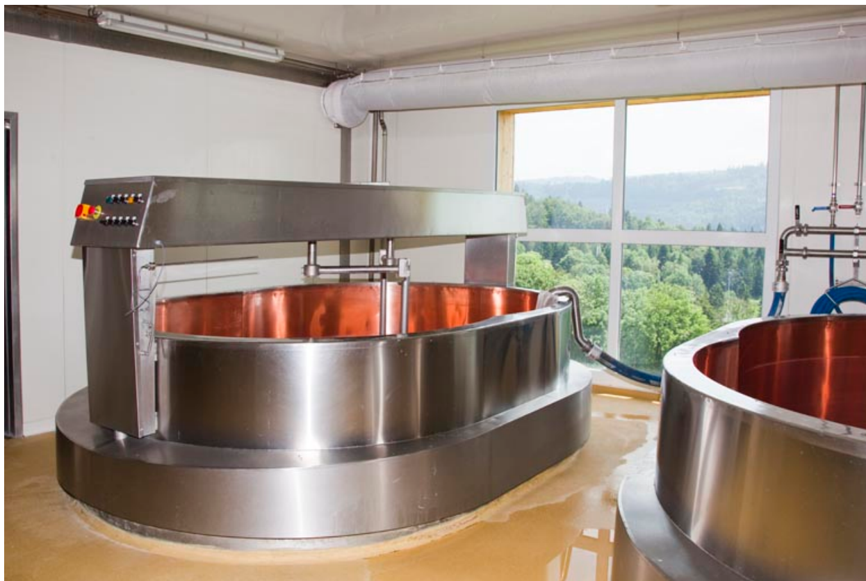
Cuve de fabrication.
