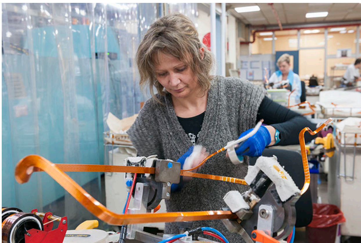
Isolation manuelle des barres de cuivre.
