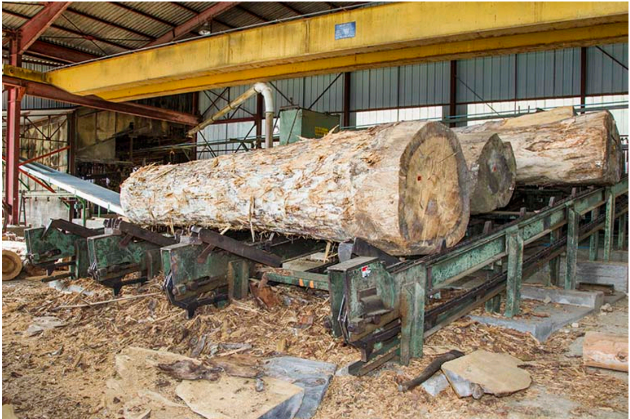
Atelier de fabrication de 1980-1982 : chariot à grumes alimentant la scie Gillet et Vigneau.
