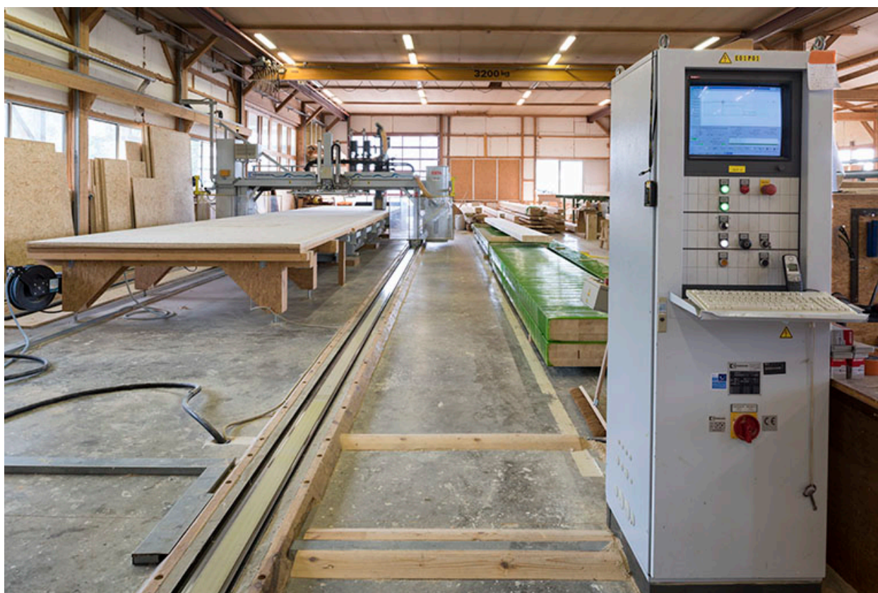
Usine de menuiserie Henri Vermot et Fils, Villers-le-Lac (unité 1 route des Fins) : pont multifonctions à commandes numériques Weinmann.
