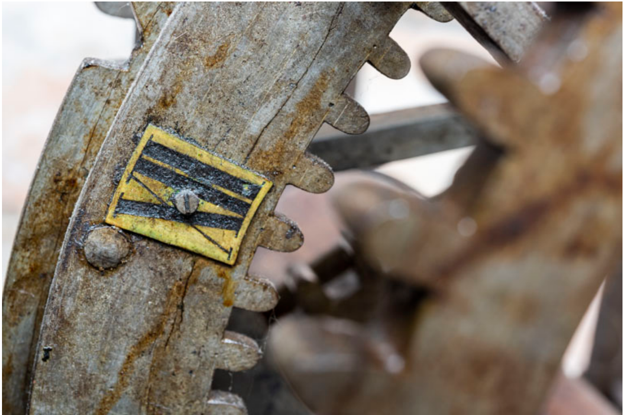
Corps arrière droit (sonnerie des quarts d'heure) : plaque en laiton rivée sur la roue de compte.
