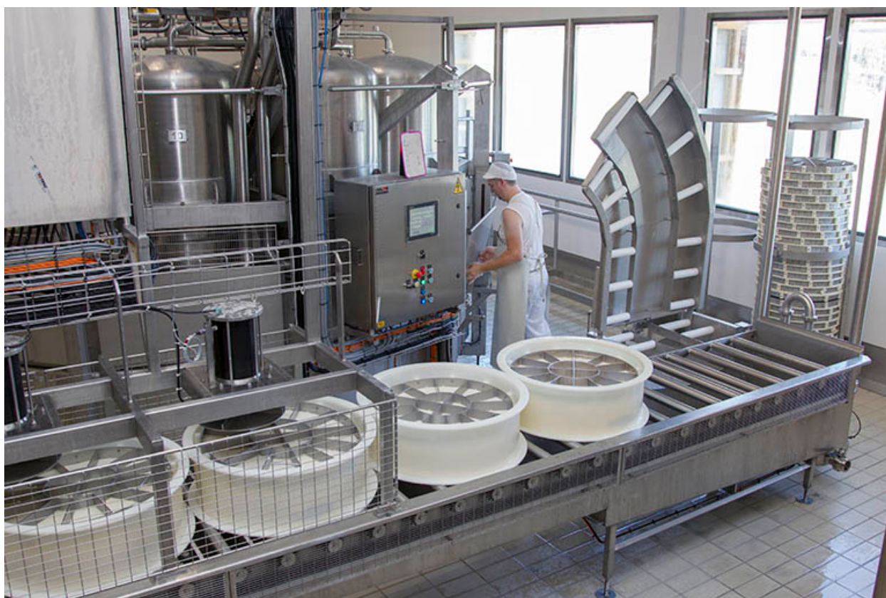
Fabrication : sortie du soutirage sous vide.
