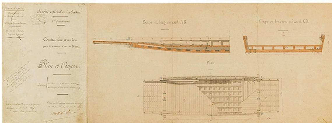
Construction d'un bac pour le passage d'eau de Gergy. Plan et coupes. 25 avril 1876.
