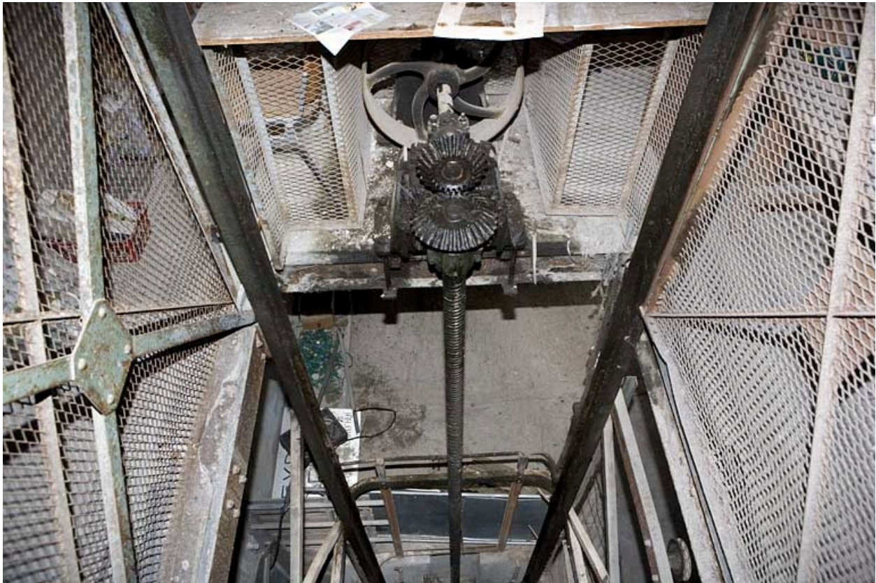
Atelier de préparation de la pâte. Monte-charge. Détail du système à vis.
