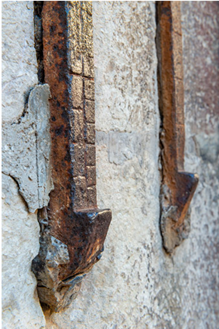
Détail des toises. Graduation double.
