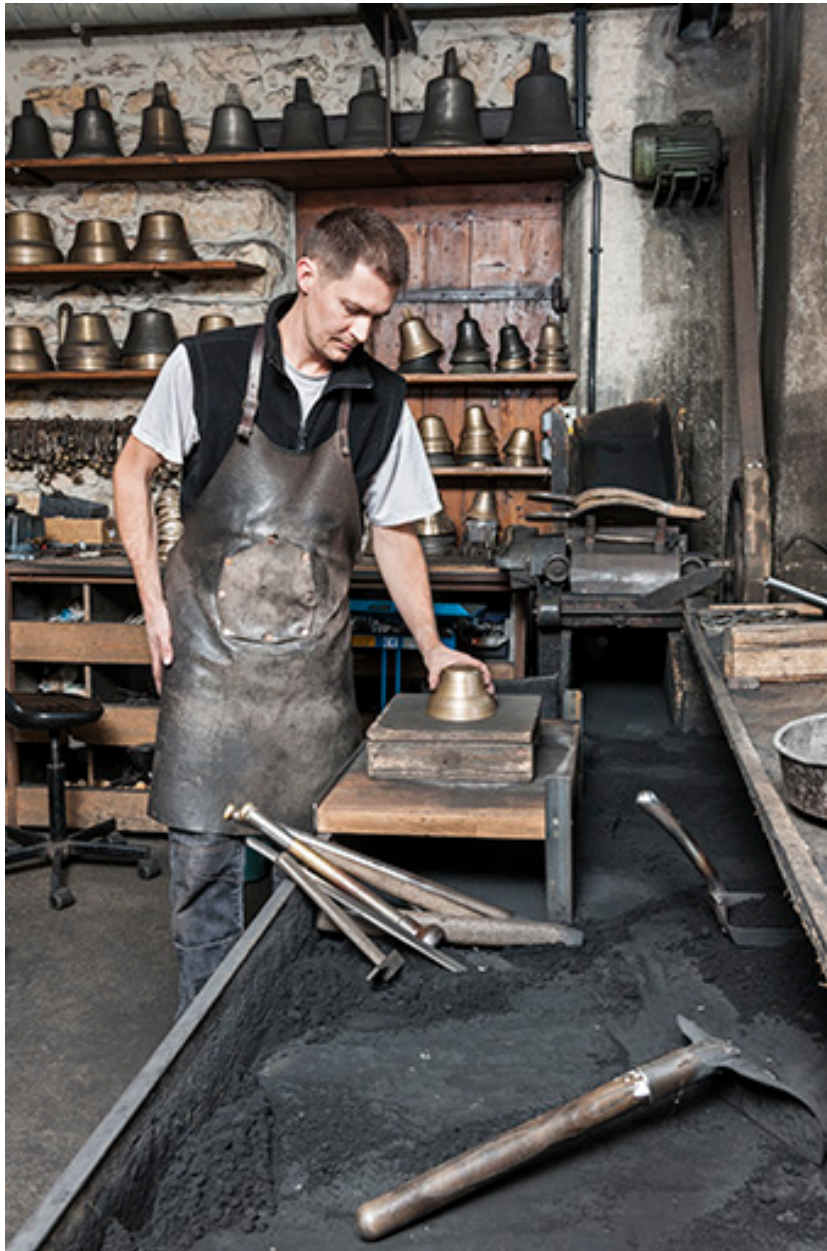
Moulage. Positionnement du modèle (donne l'empreinte extérieure).
