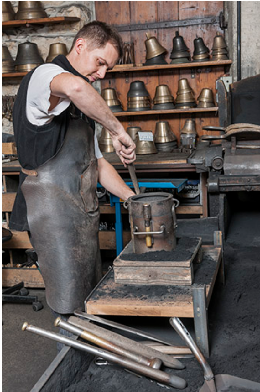
Moulage. Pose de la partie supérieure du châssis.
